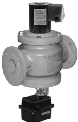
В конструкцию клапана встроена поворотная заслонка, при помощи которой осуществляется изменение количества пропускаемого газа через клапан. Конструктивно поворотная заслонка находится по ходу газа после запорного органа.
